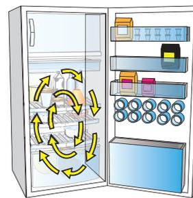
Figura 6: Correntes convectivas no interior de uma geladeira.
