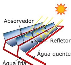
Para baratear a fabricação do espelho concentrador, uma empresa utiliza quatro longas "tiras" de espelhos planos montadas paralelamente ao tubo absorvedor, conforme mostra a figura seguinte.
