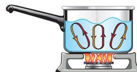
Figura 5: Correntes convectivas no aquecimento de uma massa de água.
