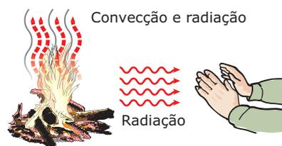
Figura 8: Propagação do calor por radiação.
