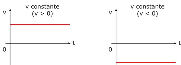
Veja, na figura seguinte, o diagrama que relaciona a velocidade  $v$  com o tempo  $t$ , para um automóvel que se move com velocidade constante de +60 km/h e que viaja durante 2 horas.
