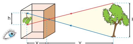
Considere uma árvore à frente do orifício. Veja a figura anterior. O observador que olhar através do papel verá uma imagem da árvore, projetada sobre a folha, que é invertida, tanto vertical quanto horizontalmente, como consequência da propagação retilínea dos raios de luz. Se conhecemos a altura da imagem ( $h$ ), a distância da árvore ao orifício ( $Y$ ) e o comprimento da caixa ( $X$ ), por semelhança dos triângulos destacados, podemos calcular a altura ( $H$ ) da árvore, ou seja:
