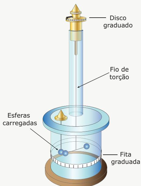
A figura a seguir mostra a haste e as esferas para o fio sem nenhuma torção.
