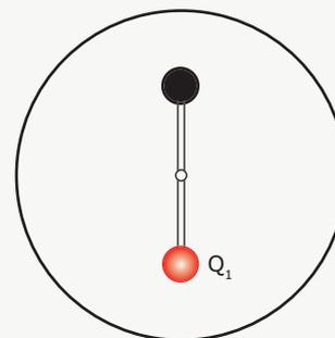
Em seguida, ele introduzia a esfera ( $Q_2$ ) pelo orifício, esperava o sistema entrar em equilíbrio e media o ângulo de torção do fio. A figura seguinte mostra uma situação de equilíbrio.
