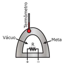
Ligando o resistor, nota-se que a temperatura indicada pelo termômetro aumenta, mostrando que há transferência de calor entre o resistor e o termômetro. Pode-se afirmar que os processos responsáveis por essa transferência de calor, na ordem **CORRETA**, são
