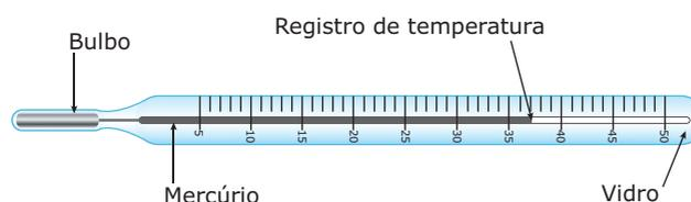
Figura 2: Termômetro clínico de coluna de mercúrio.
