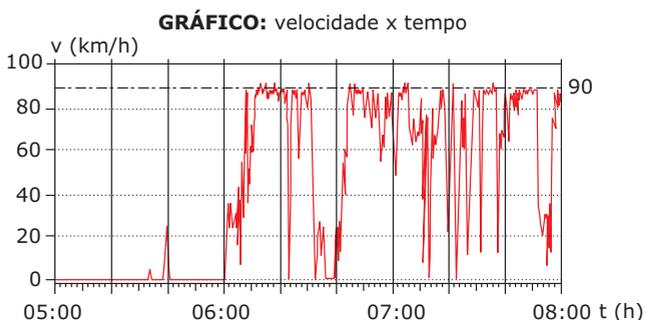
Registro de velocidade de um ônibus utilizando o tacógrafo.
