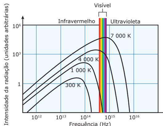
Figura 9: Curvas de radiação para diferentes temperaturas.
