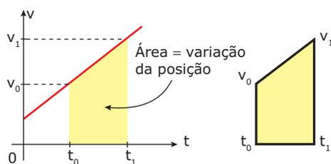
Podemos determinar a área sob a reta do gráfico calculando a área do trapézio, cujos vértices apresentam valores numéricos iguais a  $v_0$ ,  $v_1$ ,  $t_0$  e  $t_1$ . Ao calcular essa área, substituindo  $v_1$  por  $v_0 + a\Delta t$ , encontramos a função:
