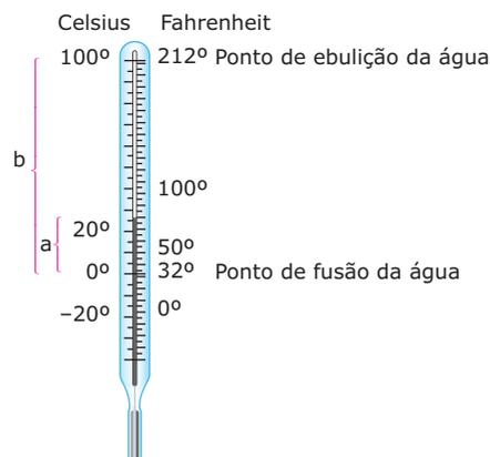
Figura 4: Termômetro graduado nas escalas Celsius e Fahrenheit.
