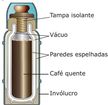
Figura 12: Mecanismos de transferência de calor em uma garrafa térmica.
