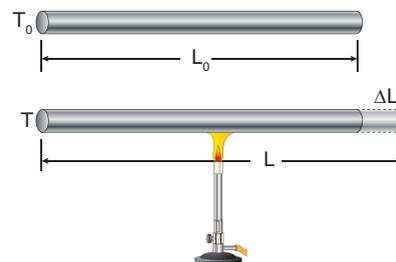
Figura 7: Dilatação linear de uma barra cilíndrica.
