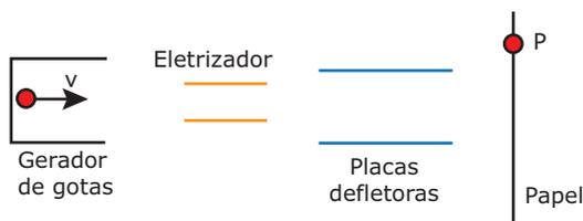
Durante o processo de impressão, um campo elétrico é aplicado nas placas defletoras, de modo a desviar as gotas eletrizadas. Dessa maneira, as gotas incidem exatamente no lugar programado da folha de papel onde se formará, por exemplo, parte de uma letra. Considere que as gotas eletrizadas são negativas. Para que elas atinjam o ponto P da figura, o vetor campo elétrico entre as placas defletoras é **MELHOR** representado pelo vetor
