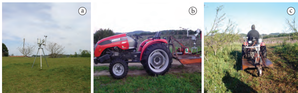
Figura 1. Estações automáticas, modelo Squitter, uma fixa próxima ao pomar (a) e outra móvel, acoplada a um trator (b e c).
