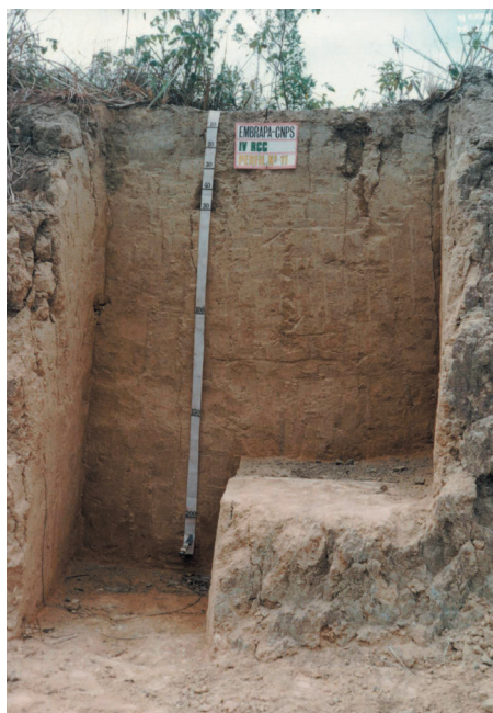
Figura 82 - Perfil de Latossolo Amarelo, Município de Campos dos Goytacazes (RJ). Foto: Virlei Álvaro de Oliveira.
