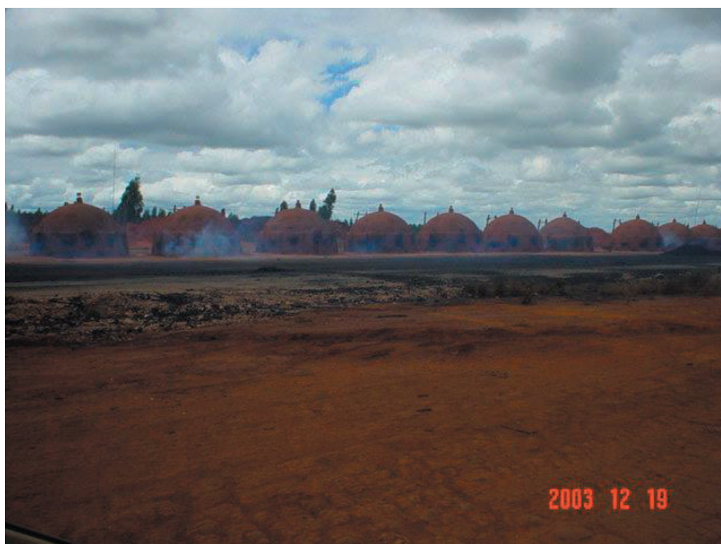
Figura 23 - Fornos para produção de carvão na região de Turmalina, norte de Minas Gerais.
