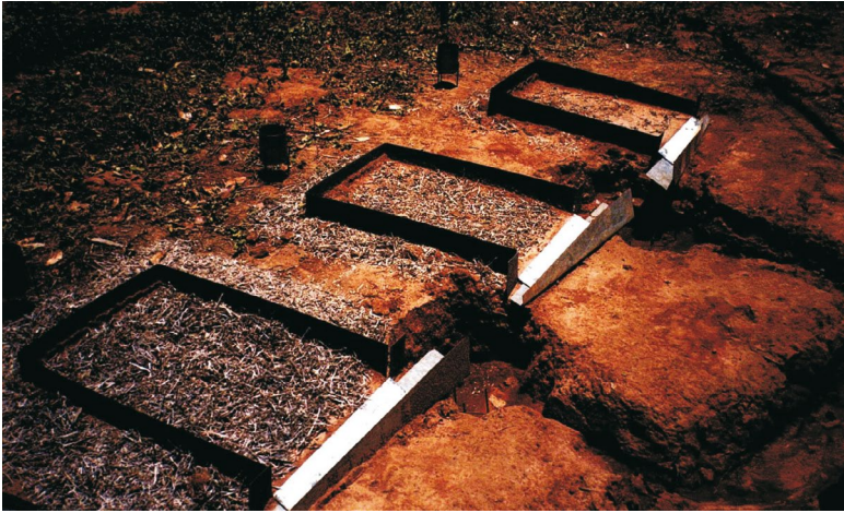
Figura 3. Parcelas experimentais de estudos da erosão em entressulcos instaladas à campo
