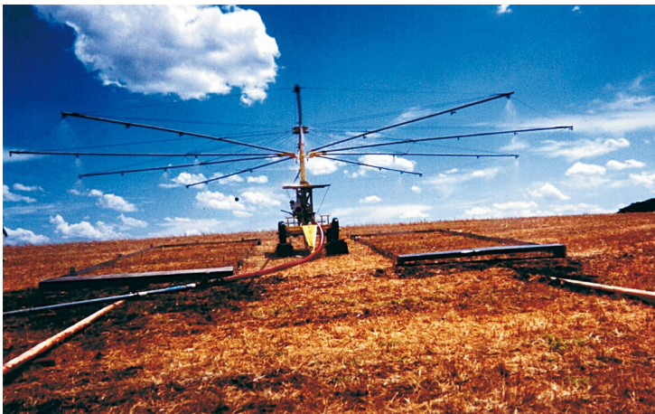
Figura 6. Simulador de chuvas de braços rotativos, utilizado na pesquisa de erosão hídrica do solo.
