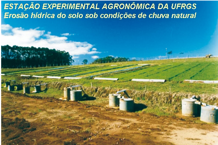
Figura 5. Ilustração de um experimento típico, sob condições de chuva natural, para determinação de perdas por erosão sob diferentes sistemas de cultivo e de manejo do solo.
